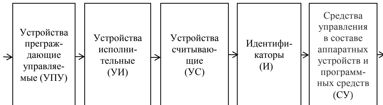
Рис. 1. Обобщенная схема надежности системы контроля и управления доступом
