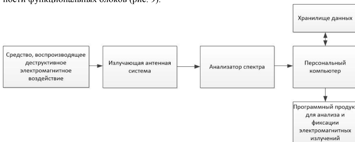
Рис. 9. Типовая схема проведения экспериментальных исследований при помощи лабораторных средств
